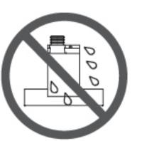
嚴禁電機、開關、接插件等電氣部件沾水,禁止用水衝洗吸油烟機。吸油烟機被水淋濕后,請不要使用,如果使用會導致漏電、觸電等事故。
