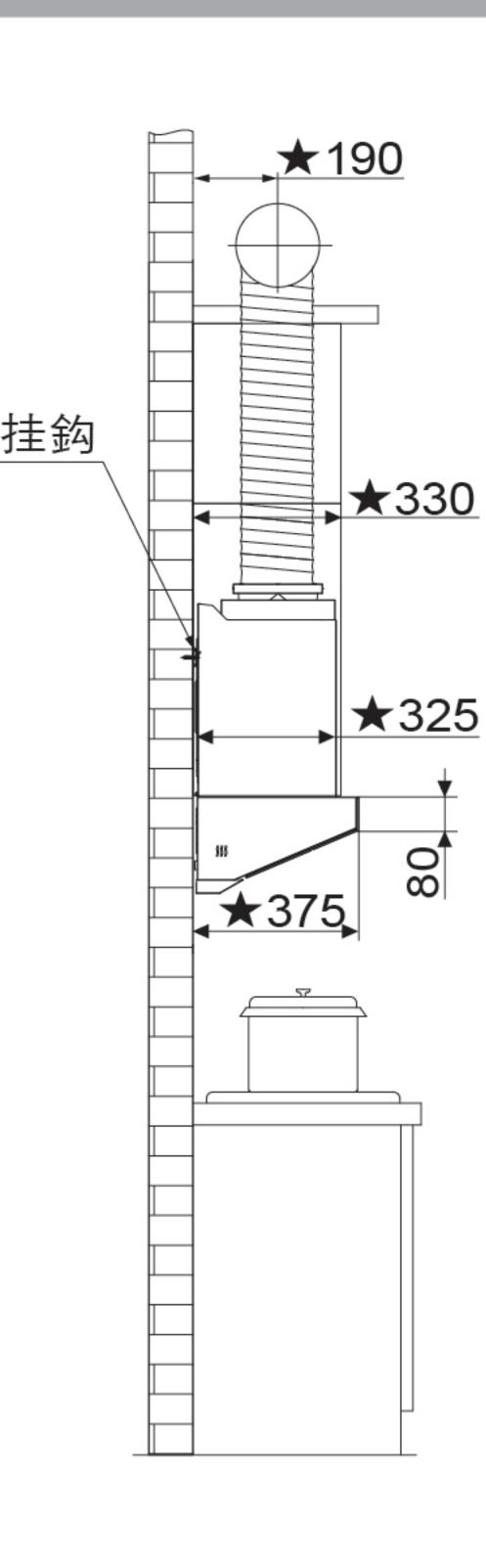
安裝示意圖 (★表示到墻的距離)
