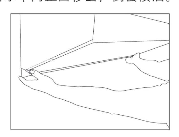
2. 輕觸電源鍵,再輕觸一下照明鍵,待隔烟屏打開到位后,拔掉電源。 雙手抓住格栅網上端,向下拉開卡扣,即可拆下格栅網。 將油杯、格栅網放入加有中性洗滌劑的温水中浸泡,用軟刷進行清潔。 清潔完畢后,按上述相反步驟安裝油杯、格栅網。
