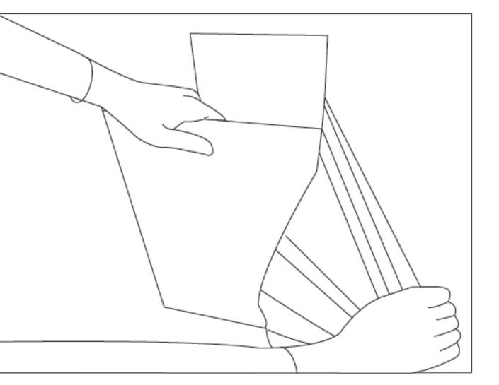
10. 安裝風機外罩和裝飾罩: (僅限已購買裝飾罩組件) 把裝飾罩放入外罩裹并同時拿起, 先把裝飾罩挂在 裝飾罩挂鈎上, 然后同時將裝飾罩、風機外罩沿裝飾 罩挂鈎推入, 風機外罩緩緩滑下, 將風機外罩上部 卡扣卡入風機架,下沿插入頂板與風機架的間隙内。
