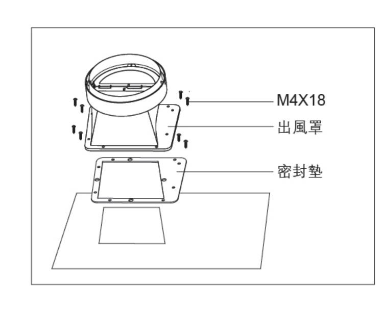
5. 布置出風管: 鋁箔出風管與預留的烟管或墻孔間須密以防漏烟,烟管不能壓變形、小角度轉響、轉彎數量不超過2個,烟管須拉直并固定。
